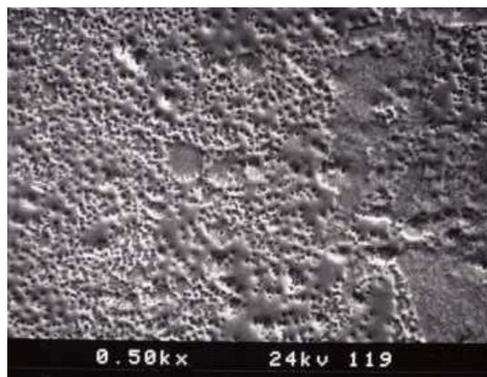
図 2 KEK エッチングによる SEM 像
