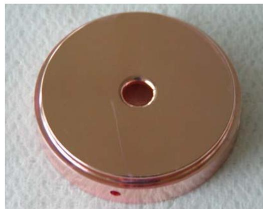
図 13 KEK エッチング前 (左図)・エッチング後 (右図) のセル凸側 (実機と同型)
